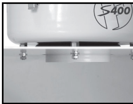
Trin 2. Monter enheden til stativet (leveres separat) og fastgør.
