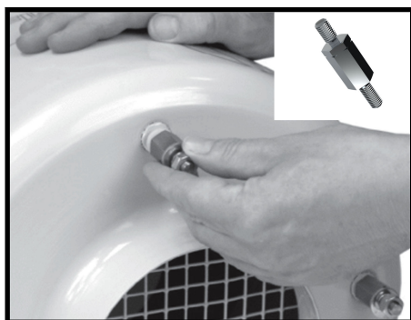
Trin 1. Monter kuffertstifter som til Direct Mount.
