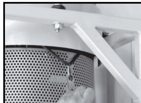
Trin 3. Fjern gammel forsegling.
