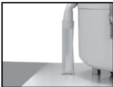
Trin 4. Monter oliereturrøret og placeringsrøret for at dræne olie tilbage til maskinkabinet, sump eller opsamlingsbeholder.
