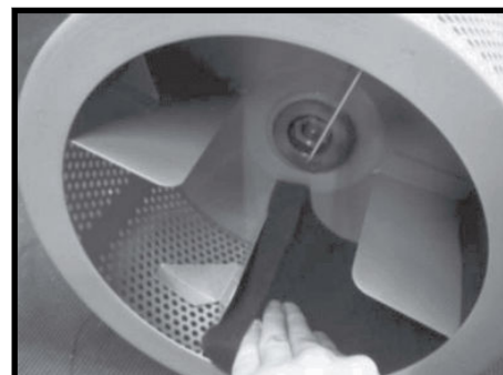
Trin 6. Monter nye tromlepuder.
