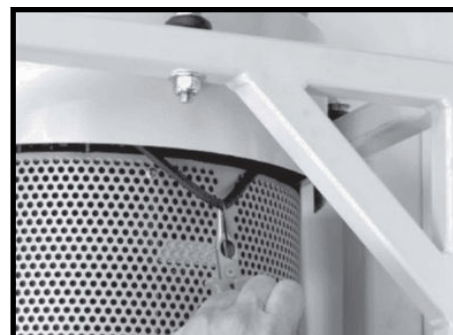
Trin 3. Fjern gammel forsegling.
